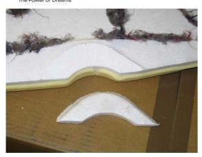
Den Styroporkörper wieder zwischen die Verstrebungen am Bodenblech legen und die restlichen Teile in umgekehrter Reihenfolge des Ausbaus montieren. Als Ergebnis ist die erforderliche Freigängigkeit unter dem Beifahrersitz gegeben.
